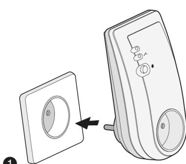
Den Empfänger direkt an die Steckdose anschließen.
