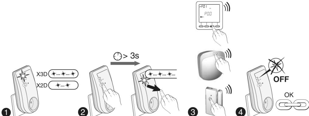
Bei Spannungs- zuschaltung (1) Warten Sie bis die Kontrollleuchte 3 Mal (X3D) oder 2 Mal (X2D) blinkt.
