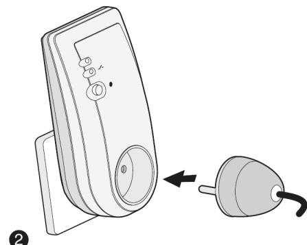
Anschließend den Stecker des zu steuern- den Elektrogeräts an den Empfänger anschließen.
