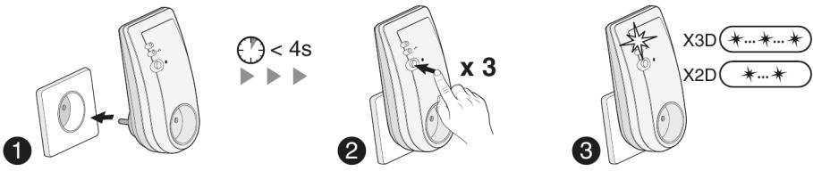
Bei Spannungszuschaltung (1) müssen Sie innerhalb 4 Sekunden 3 Mal auf die Taste (2) drücken. Die Kontrollleuchte blinkt (3): 2 Mal für X2D, 3 Mal für X3D.
